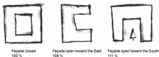
شکل ۱: مثالی از تحلیل انرژی برای فرم‌های ساخت‌وساز پایه در چارچوب توسعه شهری [۸]
