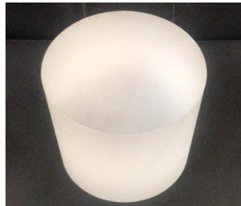
شکل ۳: تصویر استوانه کوارتز قبل از مراحل برش، سایش و پولیش.
