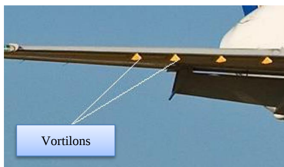
شکل ۶- ورتیلون‌های چسبیده به بال هواپیما
