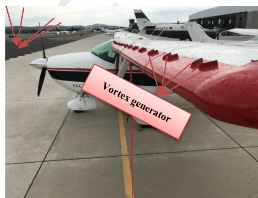
شکل ۵- مولد گرداب موجود روی بال هواپیما
