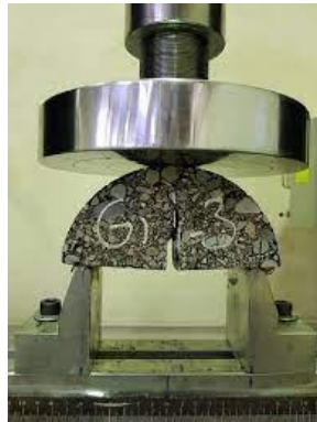
شکل ۸: قاب بارگذاری آزمایش شکست و نمونه آزمایش
