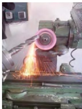
شکل (۴) استقرار مته بر روی فیکسچر و نحوه تیز کردن آن
