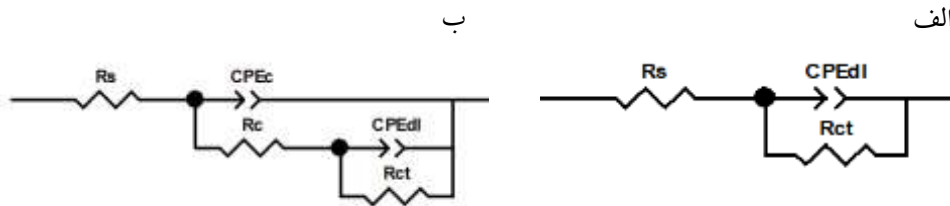
شکل ۴: مدار معادل مورد استفاده در مدل کردن الف-زیر لایه ضد زنگ ۳۰۴؛ ب- پوشش AlPO_4
