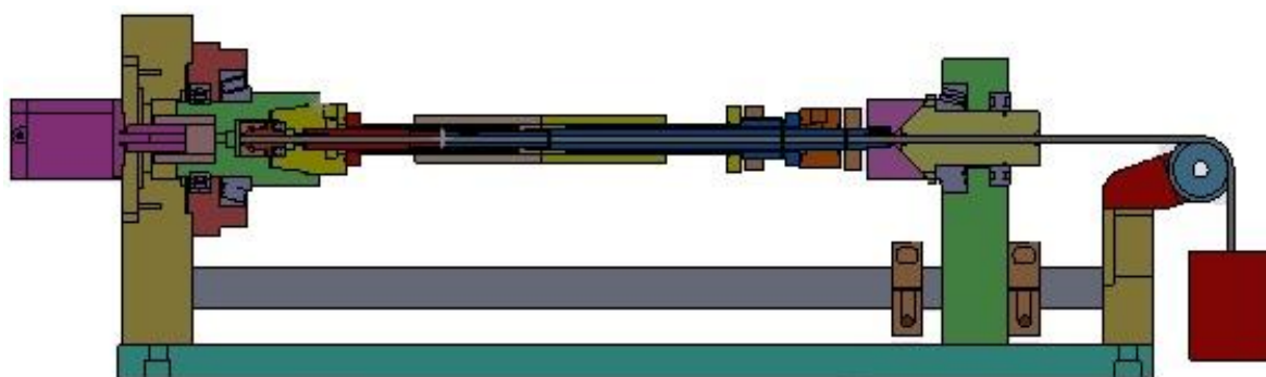
شکل ۱ مکانیزم نصب‌شده روی ماشین لیزر برای موقعیت‌دهی لوله و اعمال نیرو به درز تماس
