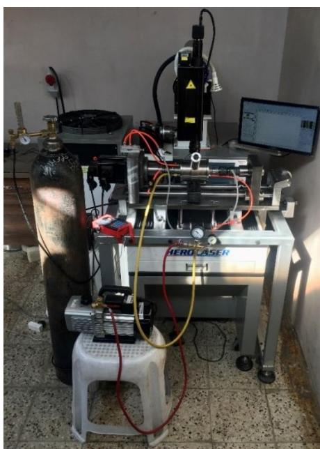
شکل ۹ ماشین جوشکاری لیزر مجهز به مکانیزم اعمال نیرو به درز و محفظه آرگون
