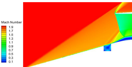
شکل ۱۶ - کانتور عدد ماخ در حالت یک حفره‌ای در نسبت پس فشار ۵/۹
