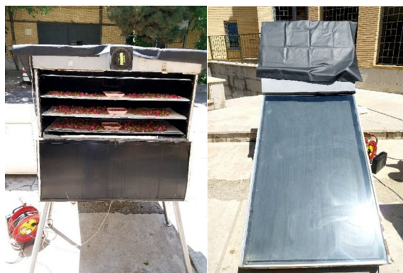
شکل 2- خشک کن خورشیدی غیرمستقیم در حین فرایند خشک کردن غنچه گل محمدی
