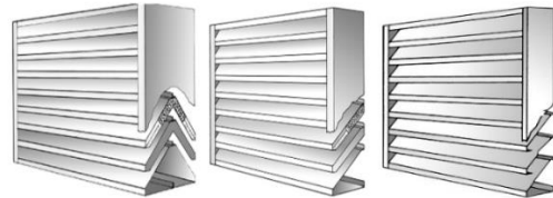
شکل ۴ دریچه ساده (راست) و دو دریچه آکوستیکی (چپ)
