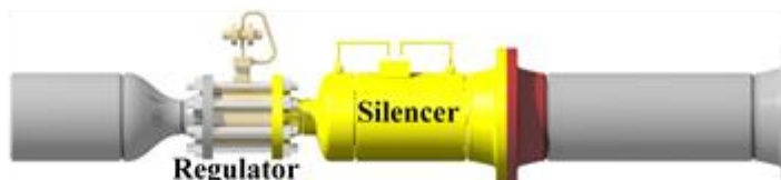
شکل ۱: صداخفه‌کن (سایلنسر) در مسیر نصب شده در پایین دست رگولاتور [۲]
