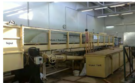
شکل ۱: نمایی از کانال آزمایشگاهی و پلان شماتیک تجهیزات آزمایشگاهی
