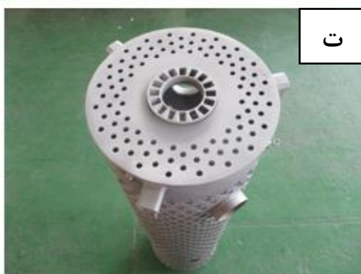
شکل ۲. الف) ترانزیشن بسته شده بر روی پره های ثابت؛ ب) ترانزیشن؛ پ و ت) محفظه احتراق.
