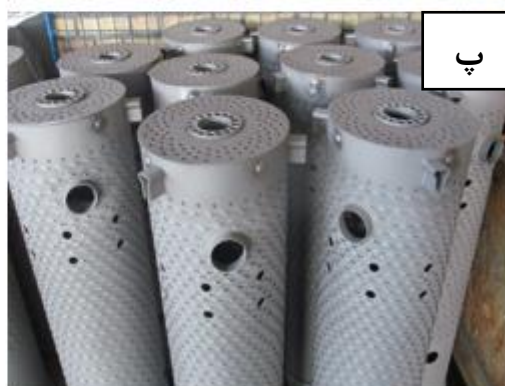
شکل ۲. الف) ترانزیشن بسته شده بر روی پره های ثابت؛ ب) ترانزیشن؛ پ و ت) محفظه احتراق.
