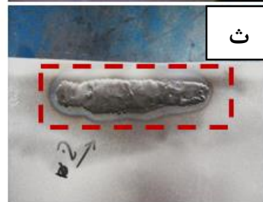
شکل ۶. الف) قسمت‌های مختلف ترانزیشن؛ ب) سایش در قسمت داخلی قاعده دایره؛ پ) سایش در براکت؛ ت) سایش در داخل سیل اسلات؛ ث، ج و چ) جوشکاری محل سایش.
