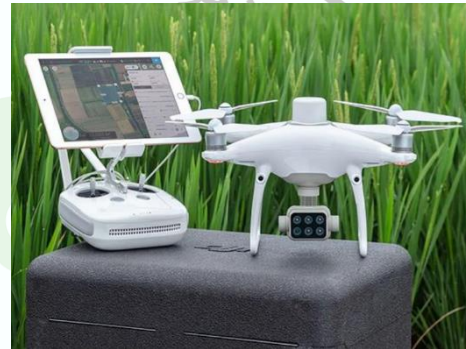
شکل ۲- پهپاد فانتوم ۴ مولتی اسپکترال (راست) و دوربین چندطیفی آن (چپ) [۹]
