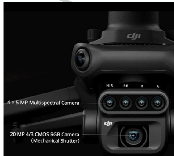
شکل ۴- دوربین های پهپاد مویک ۳ مولتی اسپکترال [۹]
