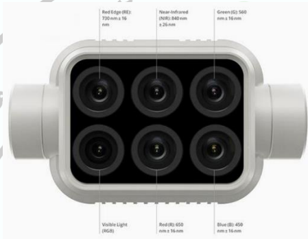
شکل ۲- پهپاد فانتوم ۴ مولتی اسپکترال (راست) و دوربین چندطیفی آن (چپ) [۹]
