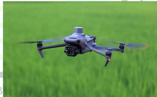
شکل ۳- پهپاد مویک ۳ مولتی اسپکترال در حالت باز شده (راست) و جمع شده (چپ) [۹]
