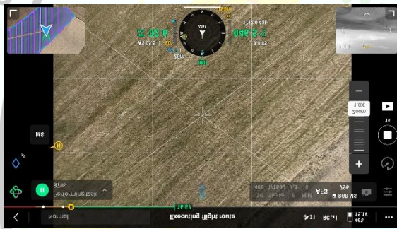
شکل ۷- مسیر پرواز پهپاد براساس DEM منطقه (راست) و تصویر دوربین پهپاد در حین پرواز (چپ)
