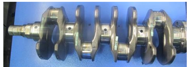
شکل ۷: بررسی یاتاقان های میل لنگ بعد از آزمون دوام رزونانسی
