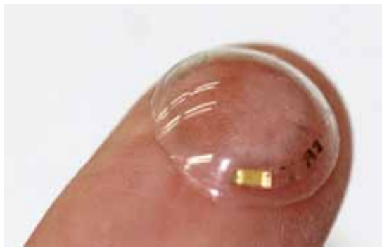
شکل ۸: اندازه‌گیری غیردخولی قند خون به کمک لنز گلوکز و ارسال اطلاعات به سامانه هوشمند [۳۱]
