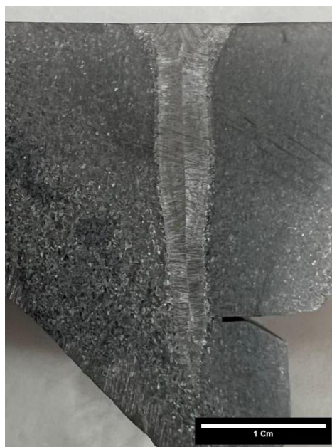
شکل 7: ماکروگرافی نمونه حاصل از جوش با بزرگنمایی 10×.
