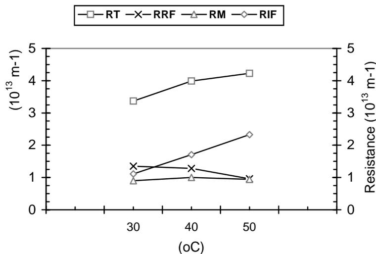
احتمالاً دلیل کاهش مقاومت برگشت پذیر با افزایش دما نیز بهبود میزان نفوذ برگشتی<sup>۱</sup> اجزاء محلول و کاهش ضخامت لایه پلاریزاسیون غلظت است.
