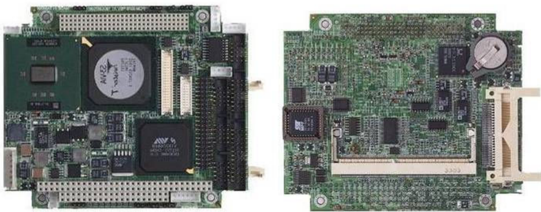
شکل ۳: نمای کامپیوتر PC-104+ با ابعاد 95 \times 115 mm
