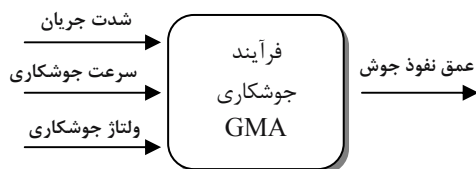
شکل ۱- پارامترهای ورودی و خروجی فرآیند جوشکاری GMA
