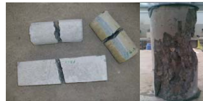
شکل ۱۴ - نمونه‌های گسیخته شده تحت آزمایش فشاری و خمشی
