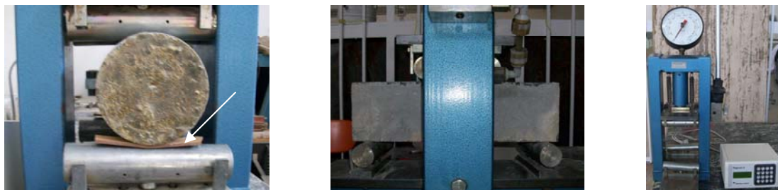
شکل ۱۰- دستگاه آزمایش خمشی شکل ۱۱- خمش چهارنقطه‌ای تیر مکعب مستطیلی شکل ۱۲- استفاده از نوار چوبی در تکیه‌گاه تیر استوانه‌ای
