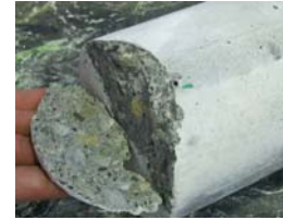
شکل ۱۳ - گسیختگی موضعی در تکیه‌گاه تیر استوانه‌ای تحت آزمایش خمشی چهار نقطه‌ای
