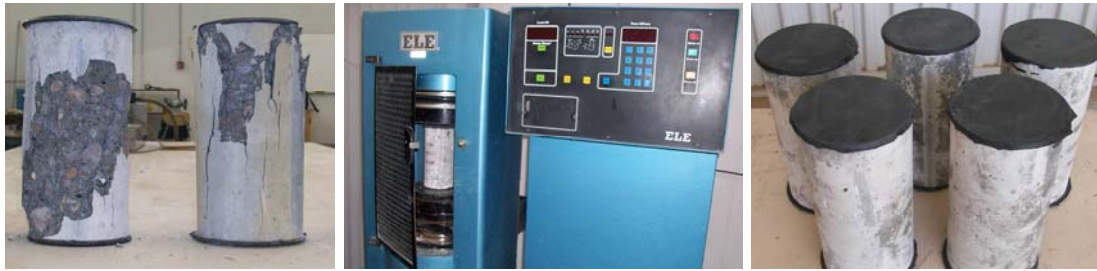
شکل ۷- نمونه‌های کلاهک‌گذاری شده شکل ۸- دستگاه آزمایش فشاری شکل ۹- نمونه‌های گسیخته شده تحت فشار
