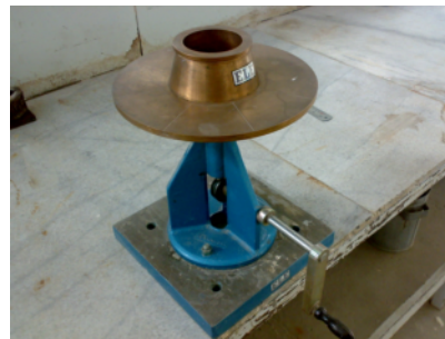
شکل ۱- میز سیلان برای تعیین روانی متعارف
