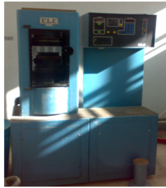
شکل ۳- چک هیدرولیکی برای شکستن نمونه‌ها
