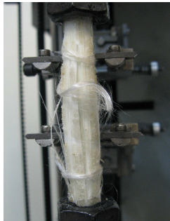
شکل ۴- شکست GFRP در تست کشش
