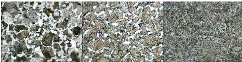
شکل 3. ريز ساختار فولاد سخت شده AISI 1045 به روش القايي، بزرگنمايي \times 500
