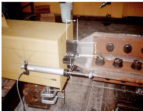
شکل ۳، نمایش قسمت محصور نشده هسته فولادی [۴]
