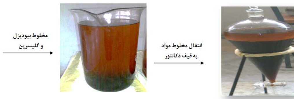
شکل 5- انتقال مخلوط بیودیزل و گلیسرین به قیف جداکننده برای جداسازی دو فاز
