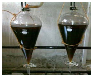
شکل 4- تخلیه مواد حاصل از فرایند استریفیکاسیون درون قیف های دکانتور برای جداسازی دو فاز
