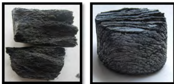
شکل ۵: تخلخل‌های ماکروسکوپی موجود در سطوح مختلف نمونه حاوی ۰/۱۵ مول خاک اره و پرس شده تحت فشار ۴۴ مگاپاسکال.
