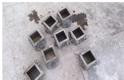
شکل ۱- قالب‌های مکعبی با ابعاد ۱۰۰*۱۰۰*۱۰۰ میلی متر
