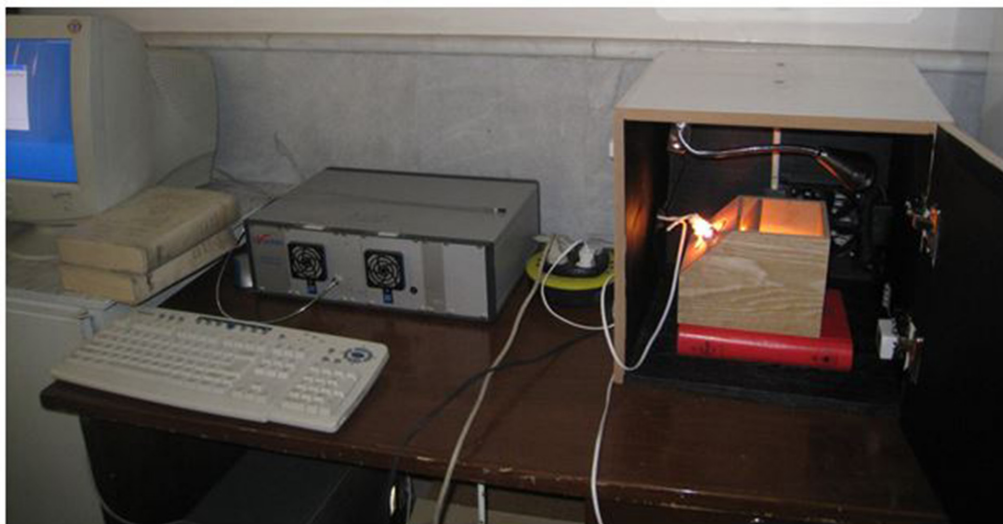
شکل (۲) مجموعه اسپکترومتر، منبع نوری، محفظه چوبی، اتاقک و رایانه جهت ثبت طیف بازتابی دانه انار
