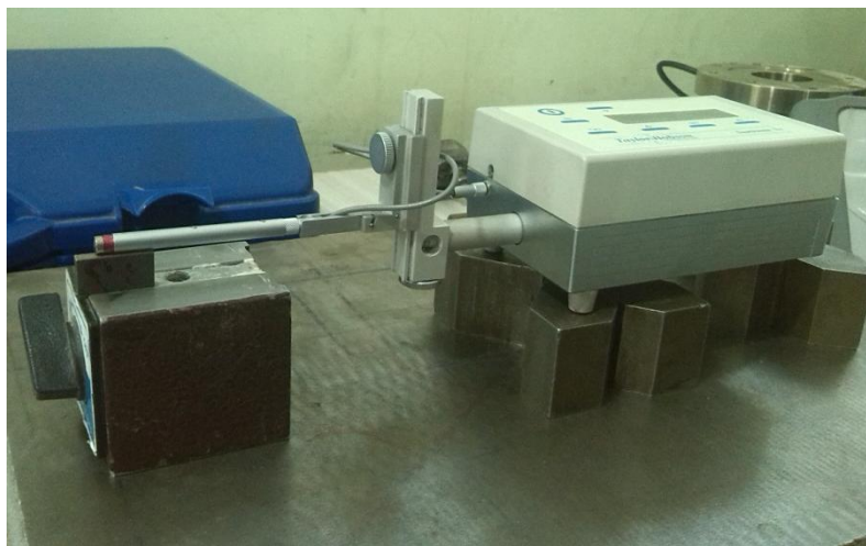
شکل ۵: اندازه گیری زبری سطح
