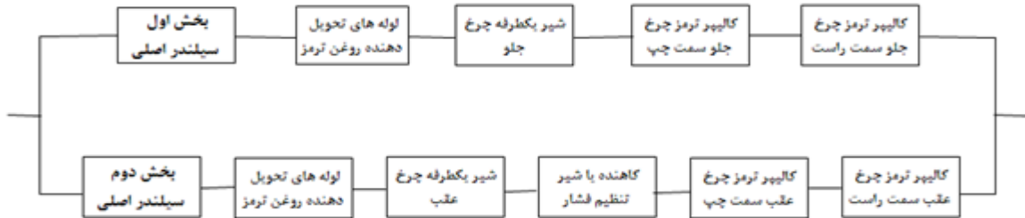
شکل ۷- نمایش بلوکی چیدمان اجزای ترمزهای هیدرولیکی
