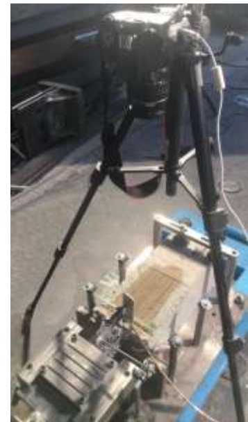
شکل ۶- دستگاه برش مستقیم ساخته شده در آزمایشگاه دینامیک سازه دانشگاه فردوسی مشهد. الف) تصویر دستگاه. ب) نیم رخ دستگاه.
