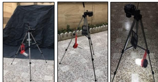
شکل ۲. سخت افزار برداشت تصاویر خرابی در شرایط کنترل شده.
