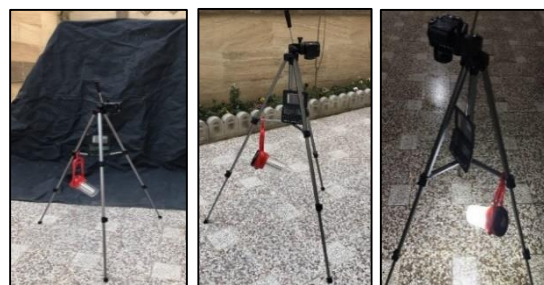
شکل ۲. سخت‌افزار برداشت تصاویر خرابی سطح روسازی آسفالتی در شرایط کنترل شده.
