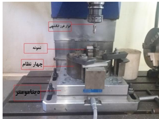
شکل ۳. محل و نحوه قرارگیری ابزار، نمونه، چهار نظام و دیناموتر. شکل ۴. نمایی از ابزار فرز انگشتی.
