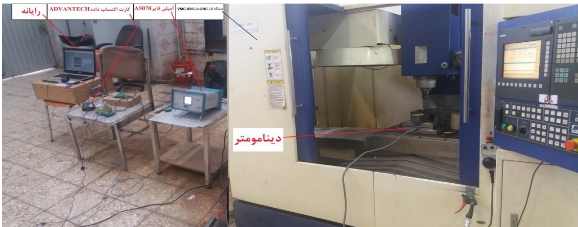
شکل ۲. نحوه قرارگیری دستگاه های مختلف در آزمایش اندازه گیری نیروی برشی.
