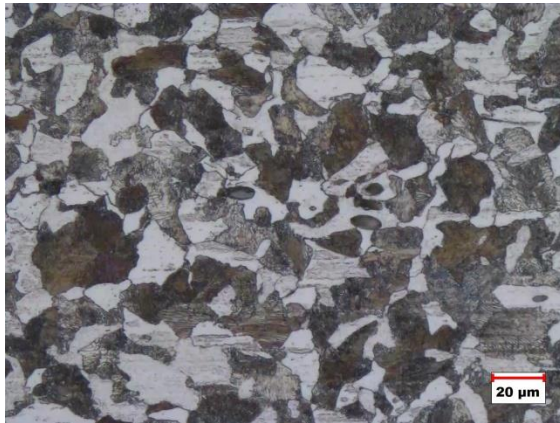
شکل ۷. تصویر ریزساختاری فولاد AISI 1045.
