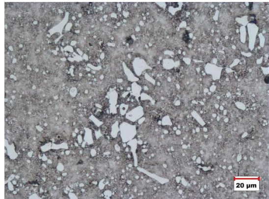
شکل ۵. تصویر ریزساختاری فولاد AISI D3.
