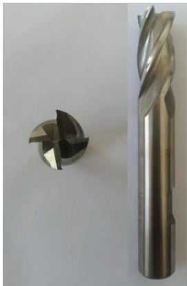
شکل ۳. محل و نحوه قرارگیری ابزار، نمونه، چهار نظام و دیناموتر. شکل ۴. نمایی از ابزار فرز انگشتی.
