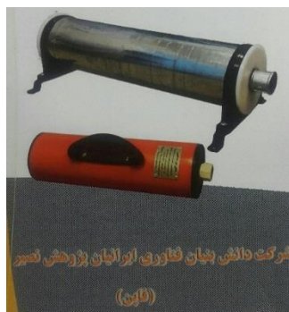
شکل ۲: نمایی از دستگاه همزن یون مغناطیسی استفاده شده در آزمایش
