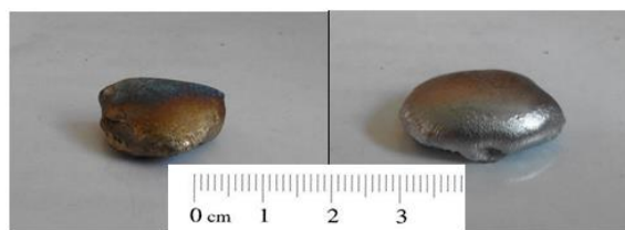
شکل ۱- نمونه OP- Alloy2، تهیه شده به روش ذوب قوسی در خلا.
