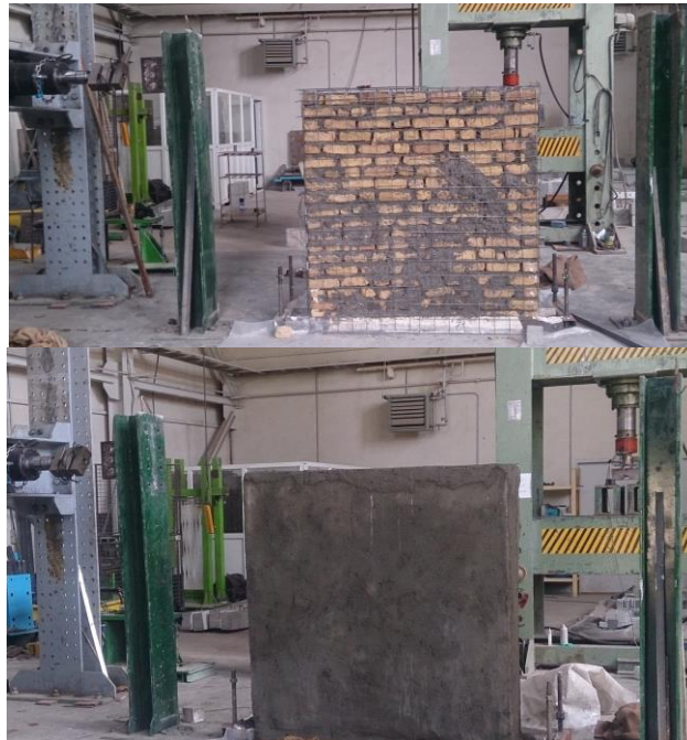
شکل ۳- مراحل اجرا و تقویت دیوار بنایی در آزمایشگاه سازه
