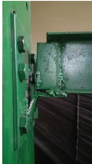
شکل ۷- گسیختگی اتصال مفصلی تیر ساده در دررفت سه درصد
